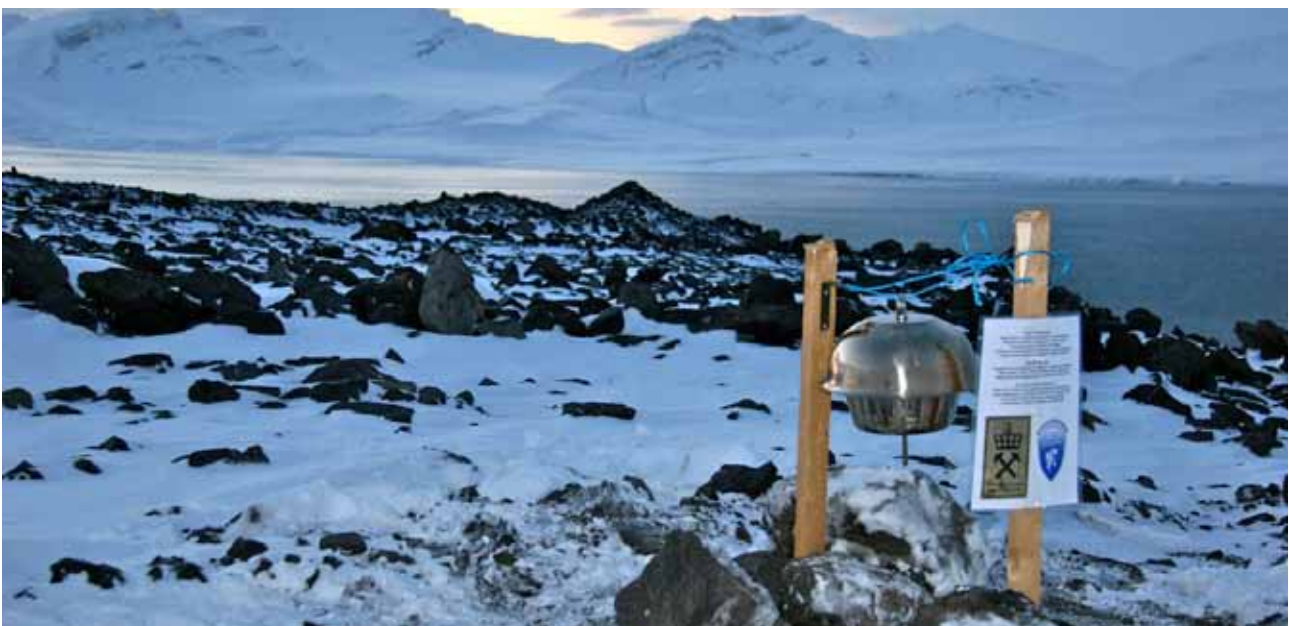
Utplassert passivt luftmåleutstyr i området ved Barentsburg. Foto: Halvard R. Pedersen
