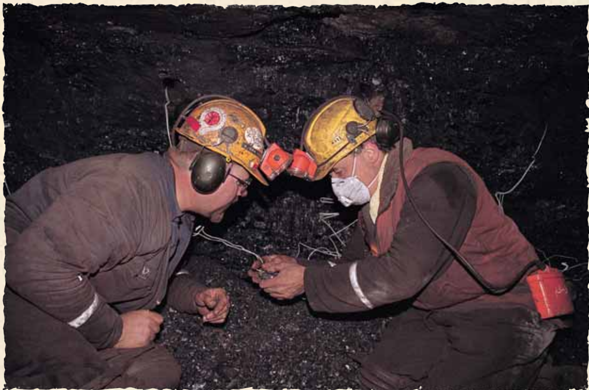
Bjørn Haug og Agnar Pettersen klargjør siste sprenging i Store Norskes Gruve 3 i Longyearbyen i november 1996. Denne gruva ble drevet etter samme prinsipp som den i Hiorthhamn.
