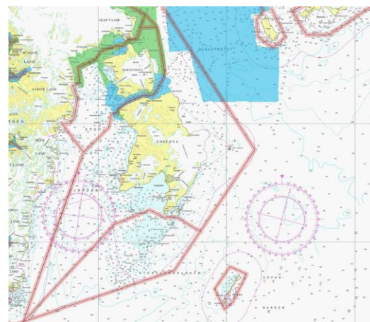
Figur 17. Utførte og planlagte sjømålinger frem til 2011. Grønne områder er sjømålt med multistråle ekkolodd, mens blå områder er målt med enkeltstråle.
